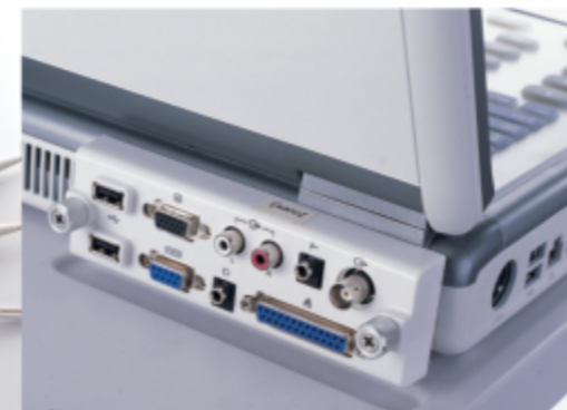
iDock™ для связи с различными периферическими устройствами
